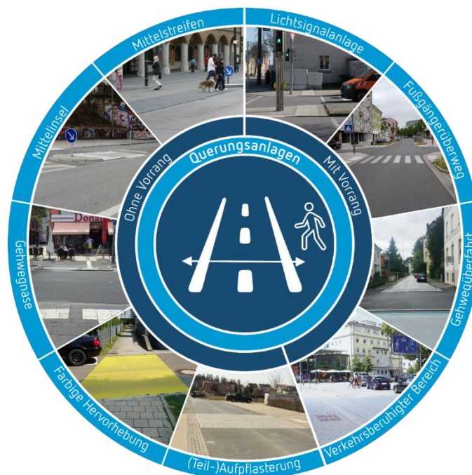
Abbildung 18: Unterschiedliche Querungsanlagen für zu Fuß Gehende
